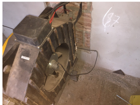
Máquina com fiação exposta e encostada na parede, não é possível realizar ajustes.
