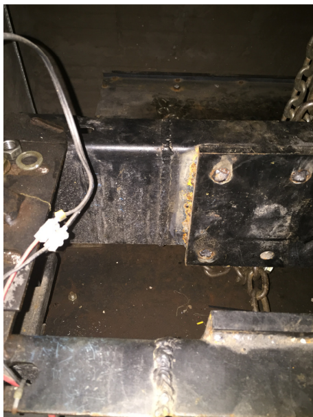
Estrutura principal com soldada (risco de fadiga)
